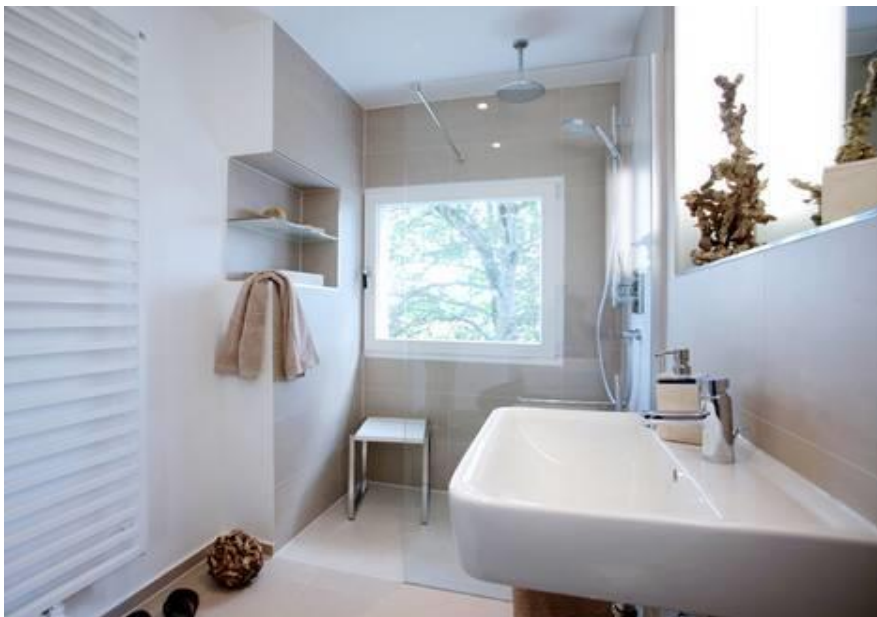
Eine bodengleiche Dusche kann ohne Hindernis betreten werden. Foto: Jörg Lantelme/ fotolia.com
